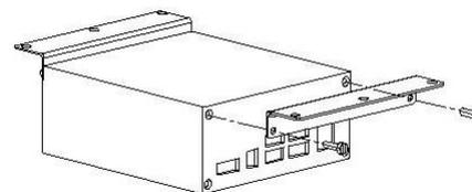
Staffe installabili nella parte superiore o inferiore degli extender – due staffe e viti incluse per ogni unità.
